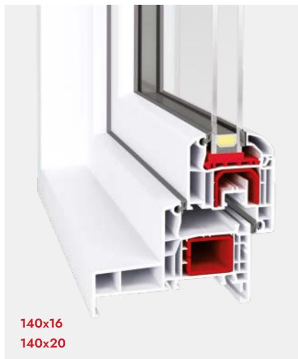
La partie extérieure du dormant qui forme une pièce d'appui permet de masquer la couche d'isolation intérieure tout autour de la fenêtre. La tapée assure une stabilité du profile et la propreté de montage grâce à l'ailette intérieure.
