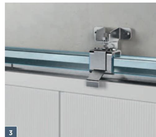
**3** **Rail de roulement** – est fabriqué en profil semi-fermé en acier galvanisé à chaud. Il est suspendu sur des supports permettant un réglage en 2 plans. Il possède à ses extrémités des butées pour empêcher le glissement du tablier en dehors du rail.
