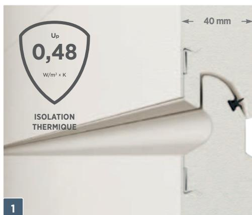
**1 Remplissage du battant** – panneaux en tôle d'acier galvanisé de 40 mm peints au polyester sur les deux faces, remplis de mousse de polyuréthane haute densité  $g = 42 \text{ kg/m}^3$  sans HCFC.
