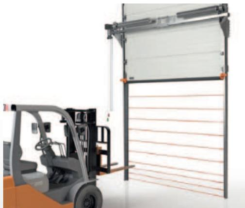
Les portes MakroTherm XXL sont équipées en standard de la protection la plus efficace, soit un rideau lumineux d'une hauteur de 2668 mm. Un réseau dense de cellules photoélectriques protège le tablier et empêche la porte de se fermer de manière incontrôlée lorsqu'il y a un obstacle dans la zone de passage.
