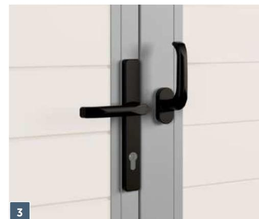
**3 Verrouillage** – le vantail de service est équipé de série d'un verrouillage 1 point – serrure à mortaise pour  $So \leq 2500$  et  $Ho \leq 2500$  mm. En plus, dans le cas des portes dont  $So > 2500$  ou le  $Ho > 2500$  mm et sur demande, un verrou supérieur supplémentaire est installé. Verrouillage du vantail semi-fixe – il est doté d'un verrouillage à 2 points (haut + bas) actionné par une crémone pompier rotative.
