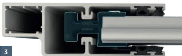
**Rails de guidage renforcés en aluminium** – adaptés pour fonctionner avec des crochets anti-vent. Montés le long des bords latéraux de la baie, équipés de joints à brosse et de glissières. Peints en standard en couleur du tablier de la porte.
