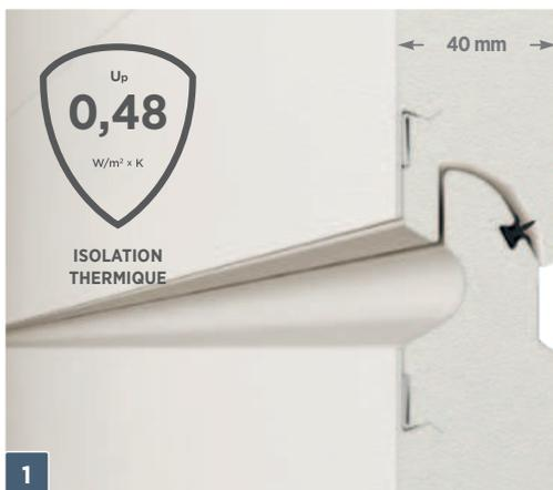
**1** **Vantail de porte** – est constitué de panneaux de porte sectionnelle de 40 mm d'épaisseur, remplis de mousse de polyuréthane sans CFC. Le coefficient de transfert thermique pour le panneau est de  $U_p = 0,48$  [ $W/m^2 \times K$ ].
