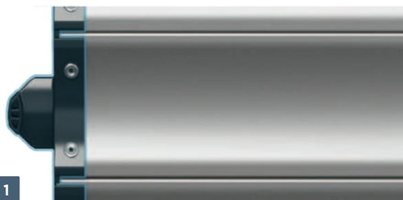
**Crochets anti-vent** – sont utilisés pour les portes dont  $S_o > 5000$  mm en équipement standard. Installés **sur chaque lame de porte**. En option supplémentaire, des crochets sont également disponibles pour les portes dont  $S_o \leq 5000$  mm. Les portes avec crochets anti-vent ont une résistance à la charge du vent de classe 3.
