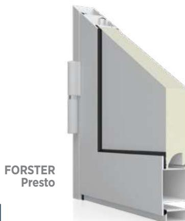
**2 Bâti** – profilés en acier, à double paroi, sans rupture de pont thermique sur le système Forster Presto. Le bâti et le vantail de la porte sont constitués de profilés de 1,5 mm d'épaisseur. Les profilés sont assemblés par soudage
