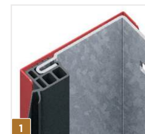
Joint latéral + cache du bâti en couleur de la porte
