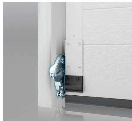
Le frein d'urgence empêchant le tablier de tomber en cas de rupture du câble
