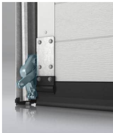
Le frein d'urgence empêchant le tablier de tomber en cas de rupture du câble
